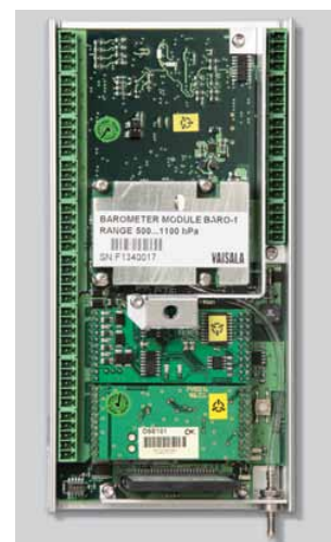
Módulo de presión localizado en la placa del CPU del QML201.
